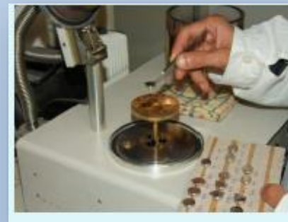
Posizionamento stub su Metallizzatore
